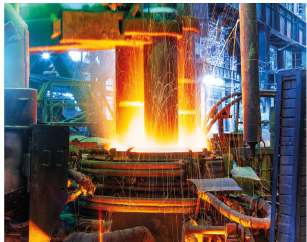
Le remplacement des hauts fourneaux par des fours à arc électrique est un levier majeur pour décarboner la production d'acier.
