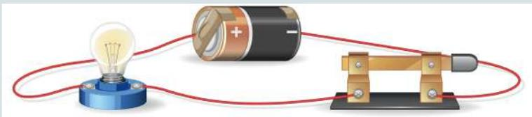
Lorsque le circuit est fermé, l'électricité peut circuler et la pile alimente la lampe.
